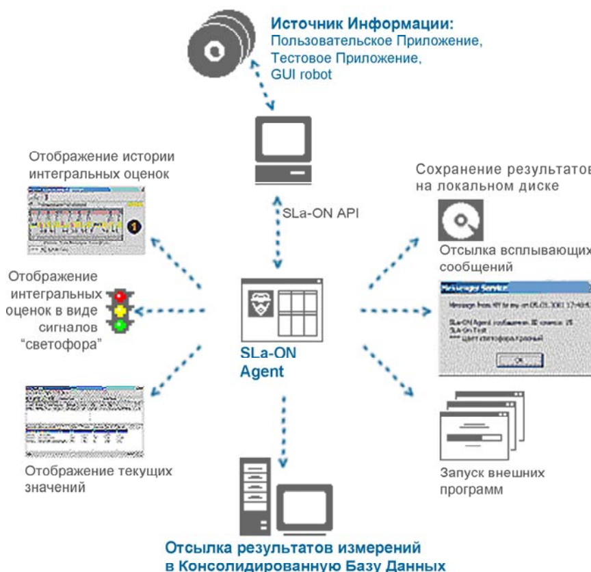
Рисунок П1.1. Функциональная схема Агента.
