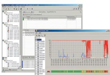
Чтобы определить причину аномальной работы IT-инфраструктуры вручную можно использовать программу Trend Viewer, для автоматического определения причин аномалий следует использовать экспертную систему NPM Visor.
